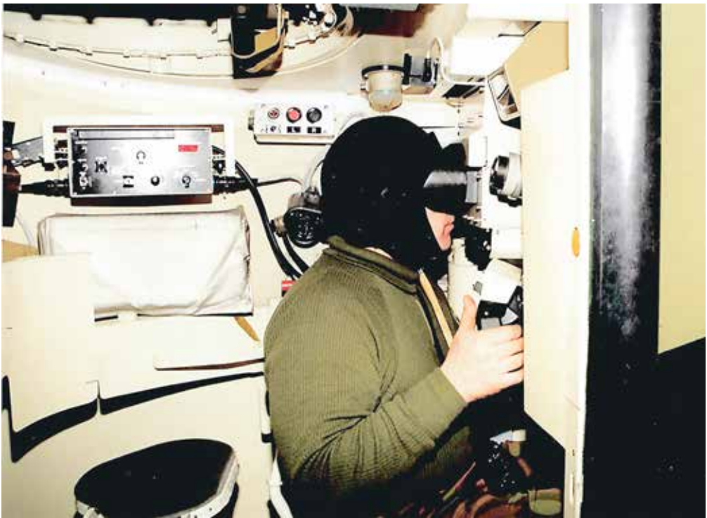
Tulitoiminnan koulutusta kehitettiin; Panssariprikaatin koulutushallin hankittiin T-72- ja T-55M -sisätila-simulaattorit. Kuvassa T-55M:n simulaattori, joka oli rakennettu vaunun todellisia sisätiloja vastaavaksi ja tulitoiminnan harjoittelu tapahtui digitaalisesti. [Panssarikoulu]
